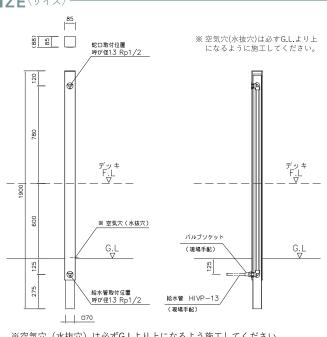
※空気穴(水抜穴)は必ずG.Lより上になるよう施工してください。 ※サドルバンド固定用のビス( $\phi$ 4×2個)は現場調達品です。 ※固定をより確実に行う場合は、付属のサドルバンドにて壁面へ固定してください(サドルバンドは壁付け施工時のみ使用可能です。)
